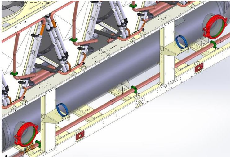
**SCHRITT 4:** Montage der Rohrleitungen mit Schellen und Victaulic-Verbindungen:
