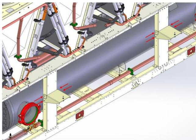
**SCHRITT 3:** Installieren Sie die Rohrschellen (blau in der Abbildung):
