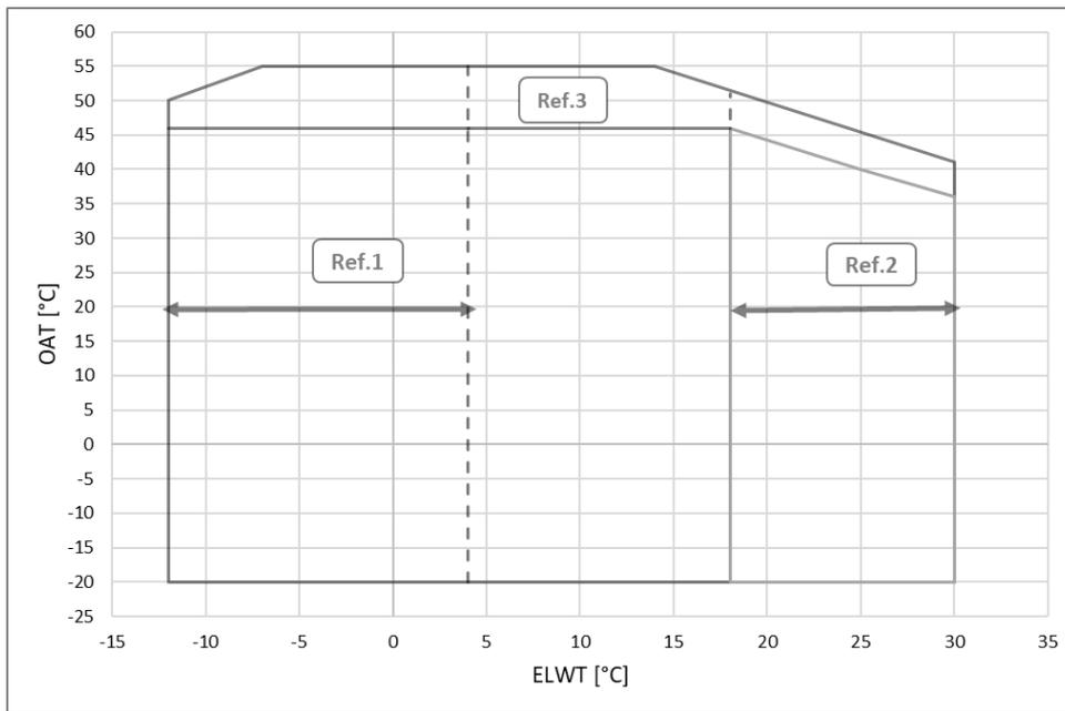
**Abb. 14 – EWFH-TZD Gold- und Platineinheit envelope**
