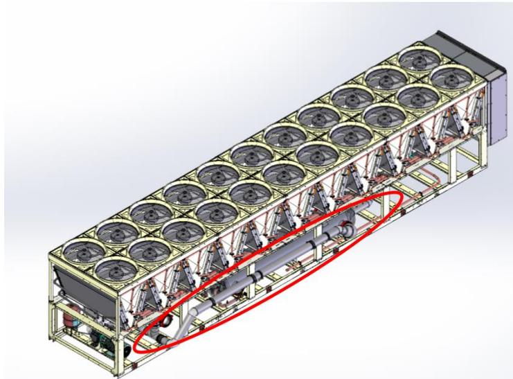
Die Baugruppe wird in einem speziellen Karton zusammen mit dem Gerät und einer Anleitung (xxx) für die Montage vor Ort geliefert. Zubehör wie z. B. die Stützen werden lose mitgeliefert und auf das Gerät selbst aufgesetzt. Für die Installation der externen Rohrleitungen ist wie folgt vorzugehen.
