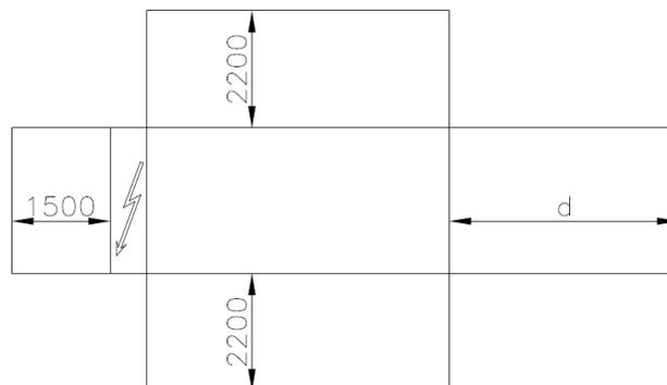
d= 1800 mm für Einkreisgeräte; d= 3000/3500 mm (je nach Verdampferabmessungen) für Zweikreisgeräte.
