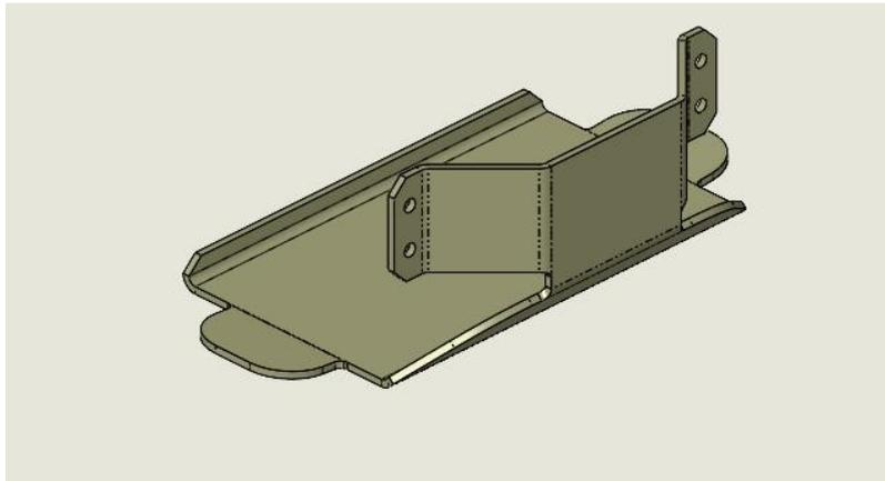
Um die Schilder zu entfernen, lösen Sie die 4 M8-Bolzen, mit denen das Schild am Rahmen der Einheit befestigt ist (siehe Abbildung unten). Wiederholen Sie diesen Vorgang an jeder Befestigung des Schildes.
