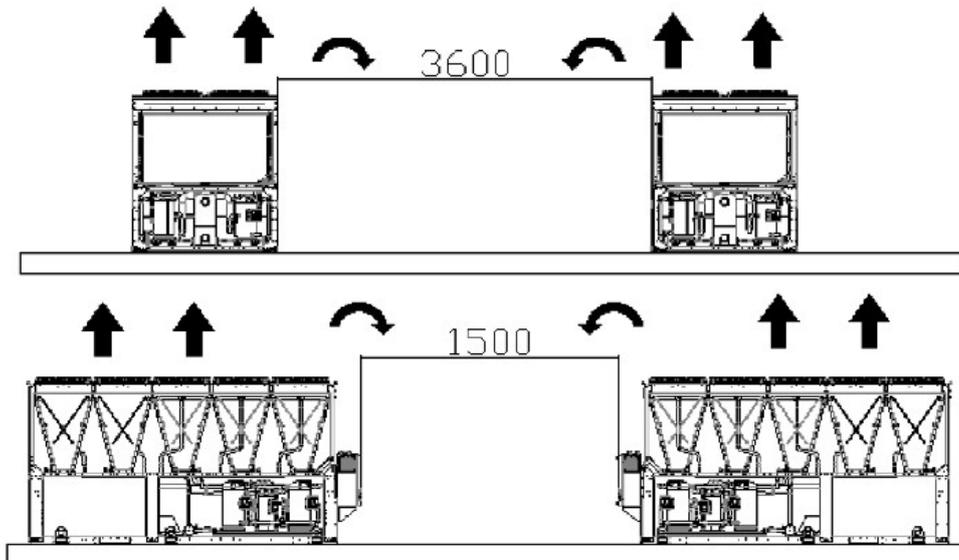
Die oben genannten Werte sind allgemeine Richtlinien. Bei der Installation des Geräts ist es von grundlegender Bedeutung, die richtigen Abstände um das Gerät herum zu berücksichtigen, um alle möglichen Wartungsarbeiten und den Austausch von Bauteilen des Geräts unter Berücksichtigung der Sicherheitsstandards durchführen zu können. Jegliche Abweichung von den Richtlinien sollte von einem lokalen Serviceanbieter geprüft werden.
