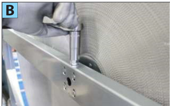
2) Die Konvergenz des Rades mit Hilfe des vertikalen Bolzens einstellen (Foto B)
