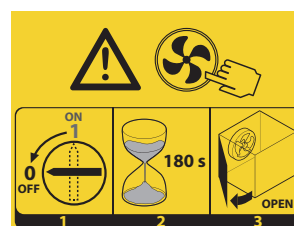
Pericolo ventilatori in funzione
