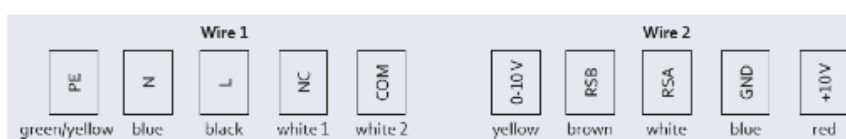
Tipo 4 con cavi di collegamento
