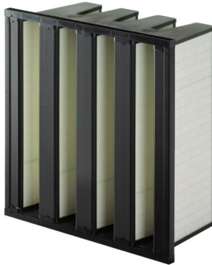
Os filtros de bolsas rígidas são feitos de fibra de vidro colocada em húmido, resistentes à humidade livre na atmosfera. O material é fabricado com duas camadas: fibras mais grossas no lado de entrada do ar e fibras mais finas no lado de saída. As duas camadas são coladas aos lados das células mediante selante de uretano.
