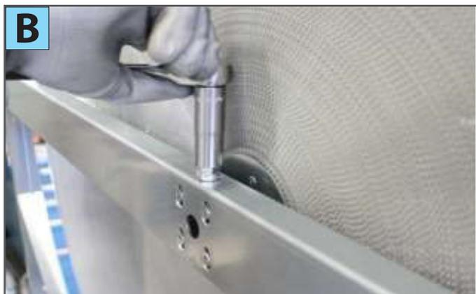
2) Regule a convergência da roda usando o parafuso vertical (foto B)
