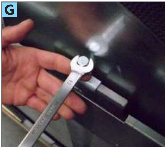
3) Reglați convergența roții cu ajutorul bulonului 2 (foto G)
