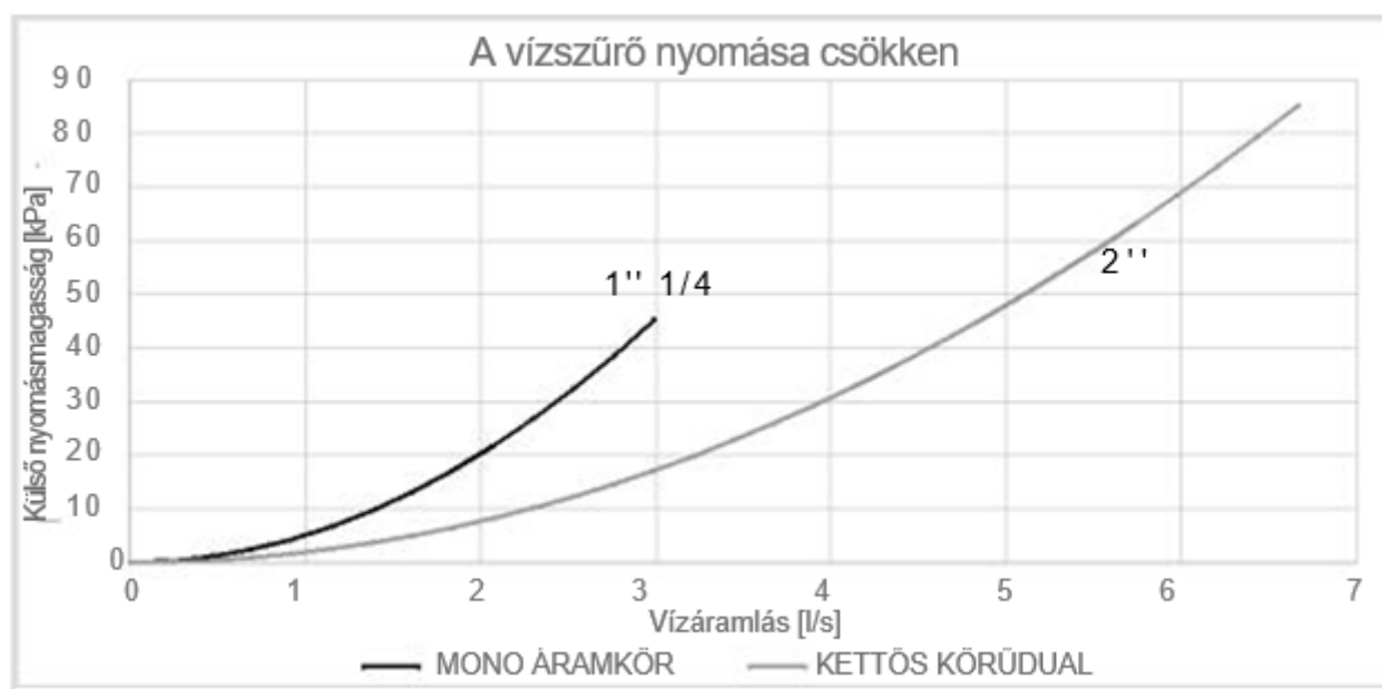
11. ábra - Vízszűrő nyomásesései
